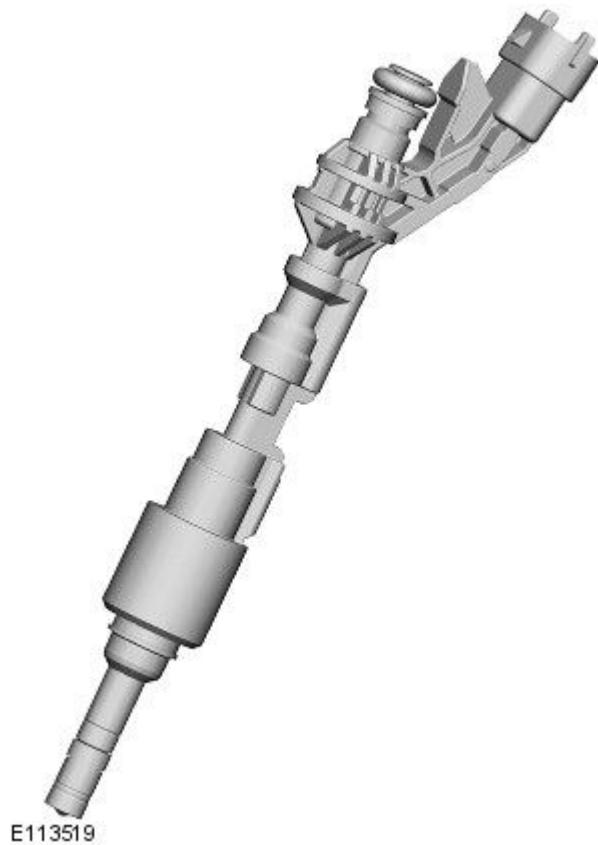
喷油嘴将燃油从燃油油轨直接喷射到燃烧室中。喷油嘴安装在燃烧室中心附近，位于进气和排气阀门之间、火花塞旁边。
